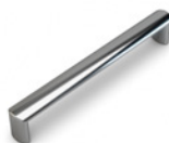
CO-091 Lunghezza: 370 mm Interasse: 350 mm Materiale: acciaio inox Finitura: cromo lucido
